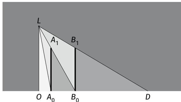
Si ha che  $x : h = (a + b) : b$  e  $x : h = (a + b + c) : c$ . Perciò  $a = \frac{b^2}{c-b}$  e  $\frac{a+b}{b} = \frac{c}{c-b}$ ; dunque  $x = h \frac{c}{b} = 1,8\frac{3}{2} \text{ m} = 2,7 \text{ m}$  (e  $a = 5 \text{ m}$ ). La risposta è 0270.
